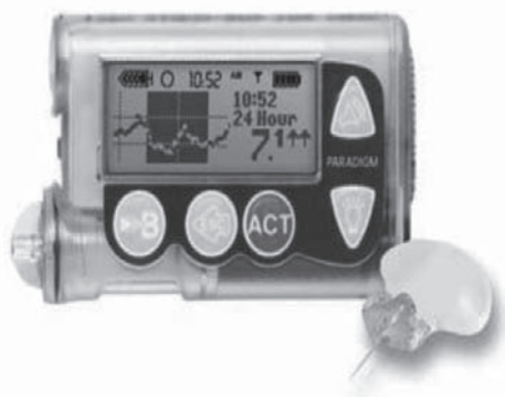
Рис. 8. Внешний вид инсулиновой помпы с обратной связью «Парадигма 722»
