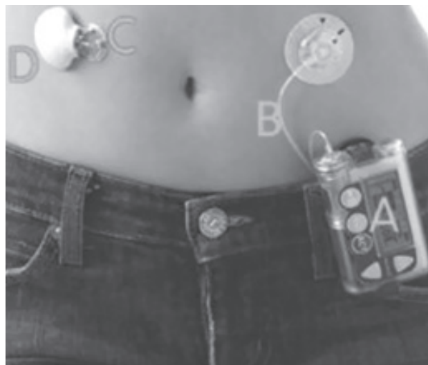
Рис. 8. Paradigm Real-Time 754 VEO (A – помпа, B – катетер для подачи инсулина, D – минилинк, передатчик сигнала с сенсора, C – сенсор)
