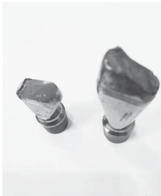
Рис. 2. Сломанные модульные шейки эндопротеза тазобедренного сустава Wright USA, удаленные в ходе ревизионных операций
