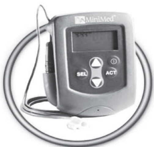
Рис. 2. Суточный монитор глюкозы крови CGMS
